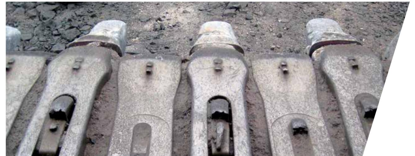
Detalle portadientes MTG Systems StarMet Rope Shovels con sistema de fijación convencional.
